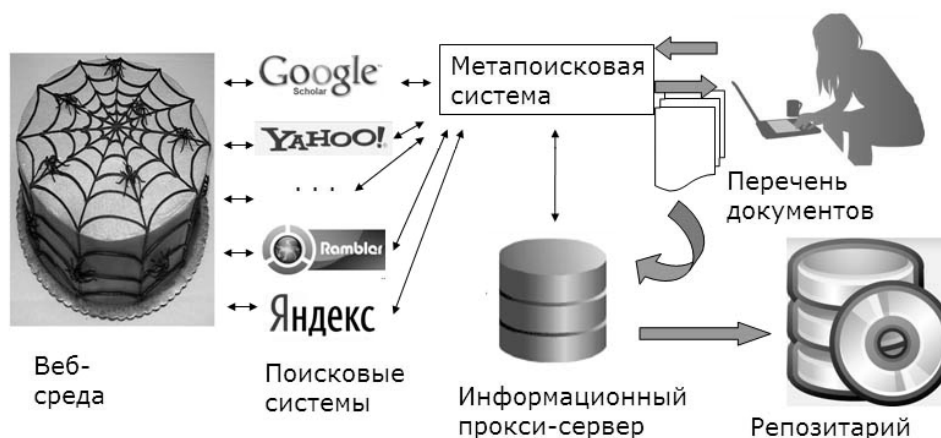
Рис. 1. Модель системы адаптивного агрегирования информации
